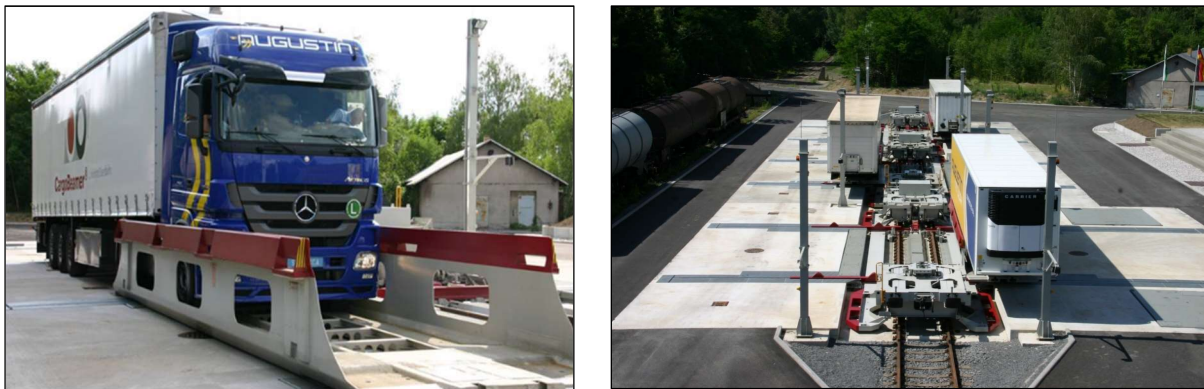
Abbildung 47: Einfahrt eines Lkw auf das System CargoBeamer 44
