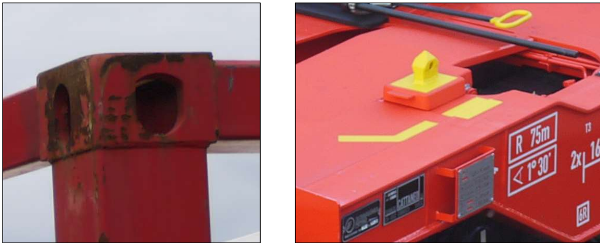
Abbildung 38: oberer Eckbeschlag (Corner castings, links) und Drehverschlüsse (Twistlocks, rechts) 38
