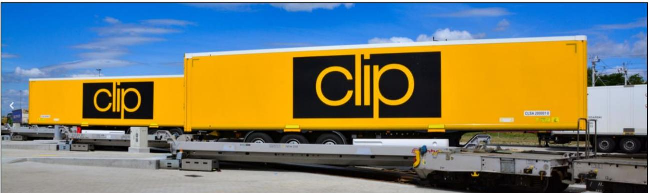
Abbildung 23: Modalohr-Umschlaganlage für nichtkranbare Trailer im KV-Terminal CLIP (Quelle: [www.clip-group.com](http://www.clip-group.com))
