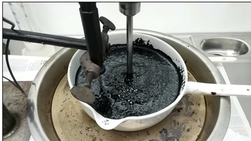
Abb. 3-2 Gummi-Bitumen-Gemisch während des Mischvorgangs
