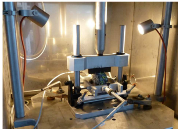
Abb. 4-3: Prüfvorrichtung Spaltzug-Schwellversuch mit eingebautem Prüfkörper (mit Durchmesser D=100 mm, Höhe H=40 mm)
