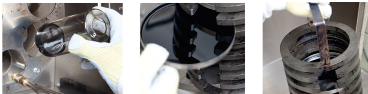
Abb. 3-2: RTFOT Gerät (links) und PAV Gerät (Mitte und rechts)
