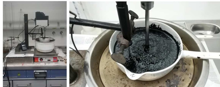
Abb. 3-1: Vorrichtung zur Einmischung von Gummi im Labor (links) und Gummi-Bitumen-Gemisch während des Mischvorgangs (rechts)
