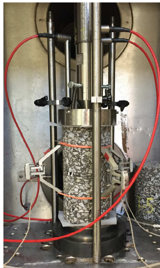
Abb. 4-7: Prüfbedingungen Druck-Schwellversuch mit eingebautem Prüfkörper (mit Durchmesser D=100 mm, Höhe H=200 mm)
